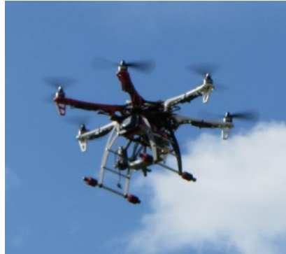
Figura 15. VANT utilizado para la toma de fotografías aéreas.
