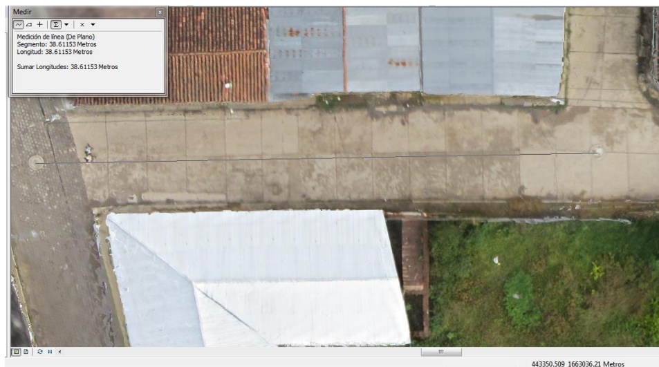
Figura 31. Cálculo de distancia entre dos puntos
